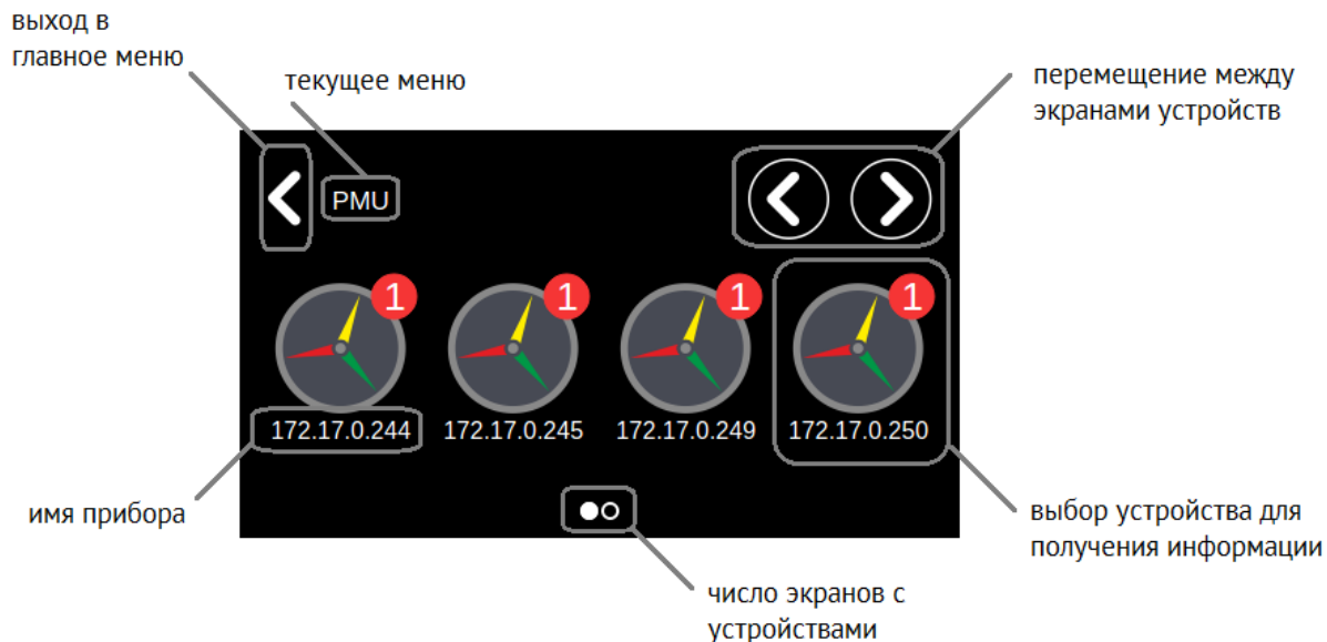
Рисунок 6.3. Второй уровень меню, сведения состоянии измерительных преобразователей с функцией поддержки синхронных векторных измерений.
